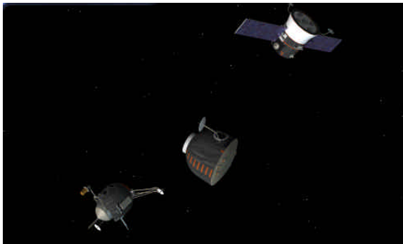
La separazione dei moduli della capsula Soyuz (Sorgente: NASA)
