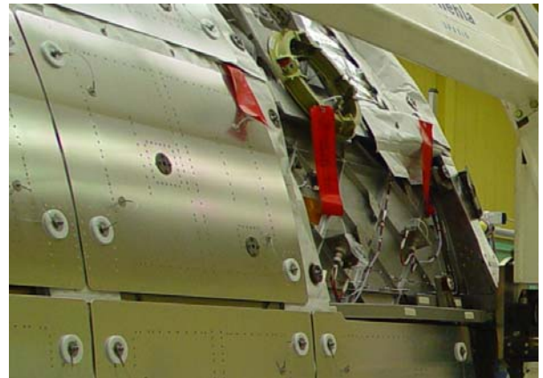
Primo piano dei pannelli del sistema di protezione contro detriti e meteoriti del Columbus. Rimosso un pannello e lo strato di copertura termica, è possibile individuare la struttura primaria. (Foto: EADS Astrium)
