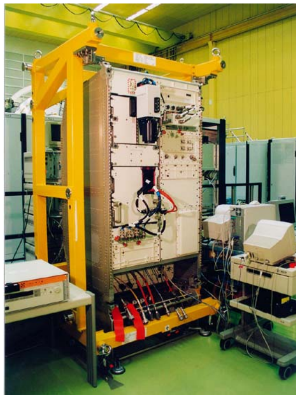
Il Laboratorio di Scienza dei Fluidi durante un test sul Rack Level Test Facility a EADS a Brema, in Germania (Foto: ESA)
