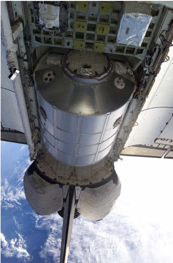
Il Modulo Logistico Multifunzionale Leonardo nella stiva dello Space Shuttle durante la missione STS-102 del marzo 2001. Il laboratorio Columbus è basato sulla stessa struttura degli MPLMs (Foto: NASA)
