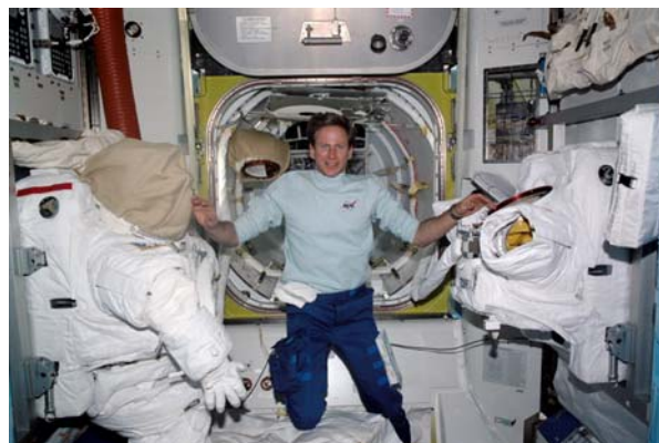
L'astronauta della NASA Michael Gernhardt nell'Equipment Lock del Quest Airlock con tute EMU durante la missione STS-104 all'ISS (12-24 luglio 2001). A destra il segmento del torace superiore che contiene i sistemi di sopravvivenza. (Image: NASA)
