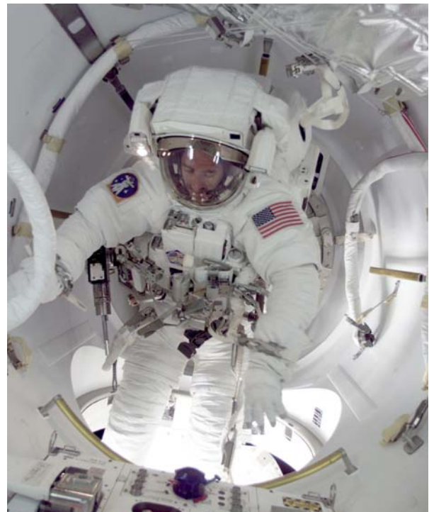
L'astronauta della NASA James Reilly esce attraverso lo Joint Airlock Quest durante la prima passeggiata spaziale dalla Stazione Spaziale nel luglio 2001. Si può vedere chiaramente l'Umbilical Interface Assembly nella parte inferiore della foto. (Image: NASA)
