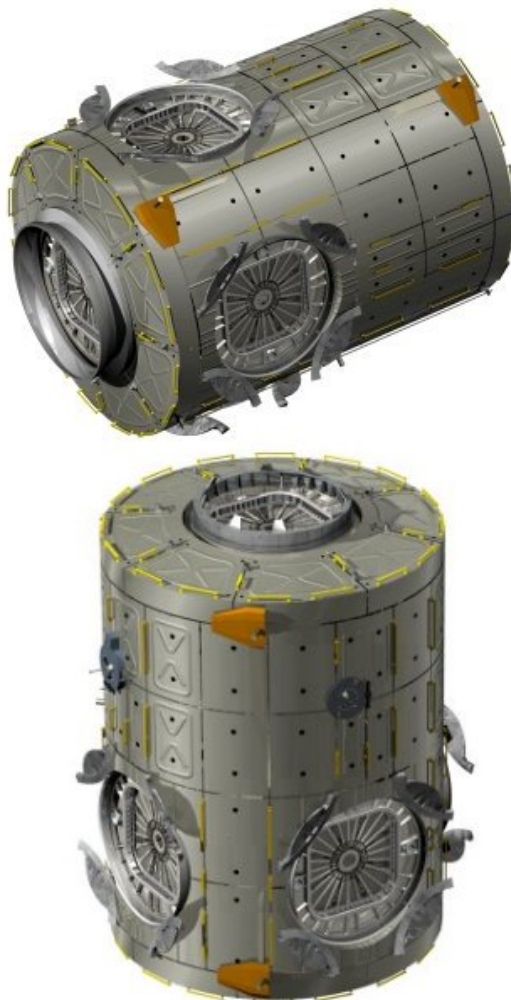
Il Nodo 2 (sopra) realizzato dall'ESA, il punto d'attacco del laboratorio Columbus e il Nodo 3 (sotto). Il Nodo 3 sarà il punto d'attacco della Cupola. (Immagine: ESA/D. Ducros)
