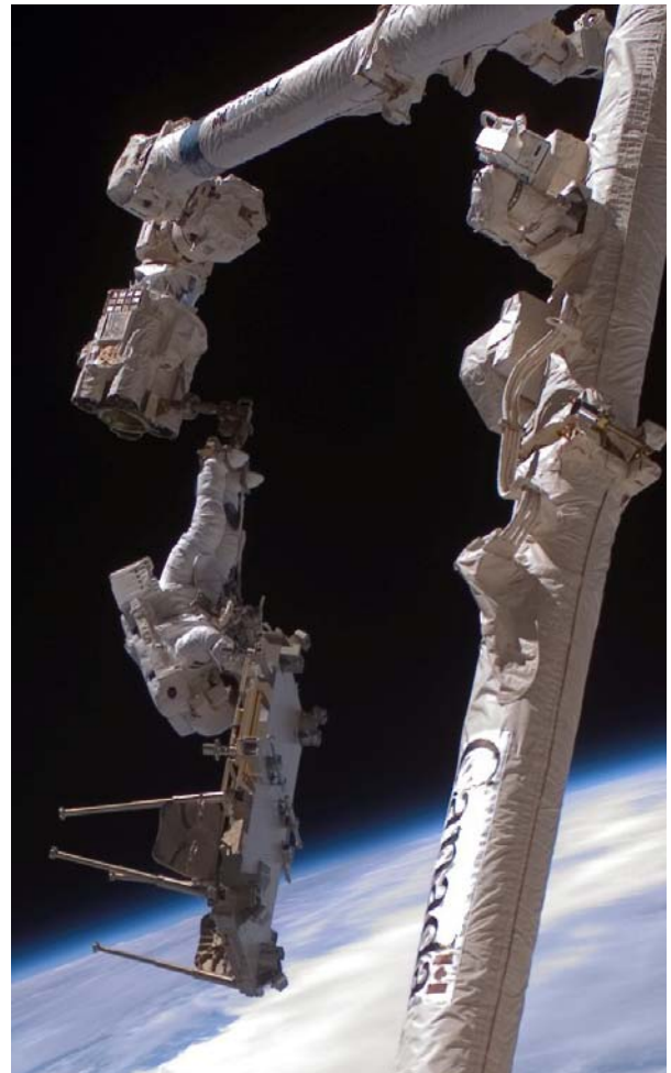
L'astronauta dell'ESA Christer Fuglesang durante la seconda EVA sulla ISS 12A.1 missione d'assemblaggio a dicembre 2006. Legato al braccio robotico della Stazione tramite una piattaforma, Fuglesang ricolloca un pezzo dell'hardware dell'EVA ad una posizione diversa sul traliccio della ISS per disimpegnare la posizione per le attività del terzo EVA. (Immagine: NASA)
