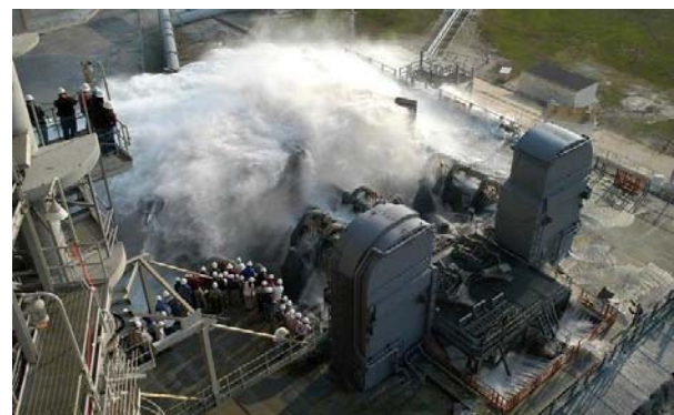
Il controllo del Sound Suppression System sulla base di lancio 39° al Kennedy Space Center. (Immagine: NASA)
