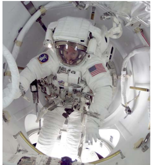
NASA-astronaut James Reilly lämnar den gemensamma luftslossen Quest under den absolut första rymdpromenaden från den internationella rymdstationen i juli 2001. En tydlig bild av Umbilical Interface Assembly kan ses vid bildens nederkant. (Bild: NASA)
