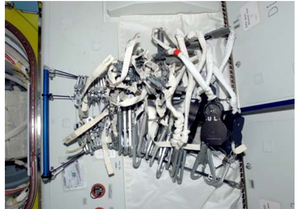
Vy av EVA-förankringar och förankringslinor i Quest-luftslussen på den internationella rymdstationen. (Bild: NASA)
