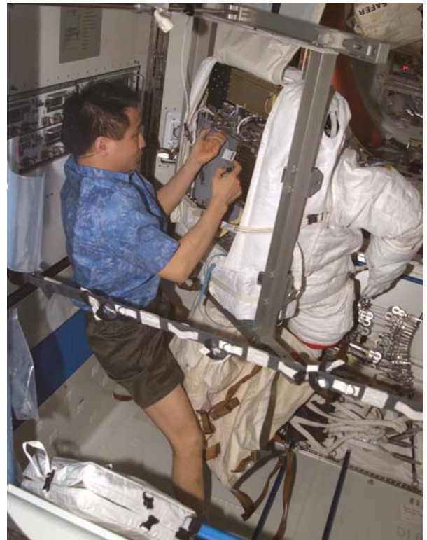
NASA-astronaut Ed Lu genomför återkommande underhåll av en EMU i Quest-luftslussen. (Bild: NASA)
