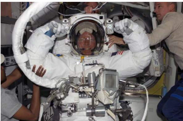
Överst: expedition 13 flygingenjör Jeff Williams håller i SAFER-enheten (till höger i bilden) innan den sätts fast. Nederst: STS-121 uppdragsspecialist Michael Fossum håller upp armarna medan SAFER-enheten fästs till hans EMU av STS-121 uppdragsspecialist Stephanie Wilson och Jeff Williams. (Bild: NASA)
