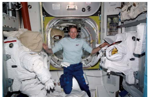
NASA-astronaut Michael Gernhardt i utrustningsslussen i Quest-luftslussen med EMU-rymddräkter under STS-104-uppdraget till ISS (12-24 juli 2001). Till höger ses överdelssektionen, vilken innehåller de livsupprätthållande systemen. (Bild: NASA)
