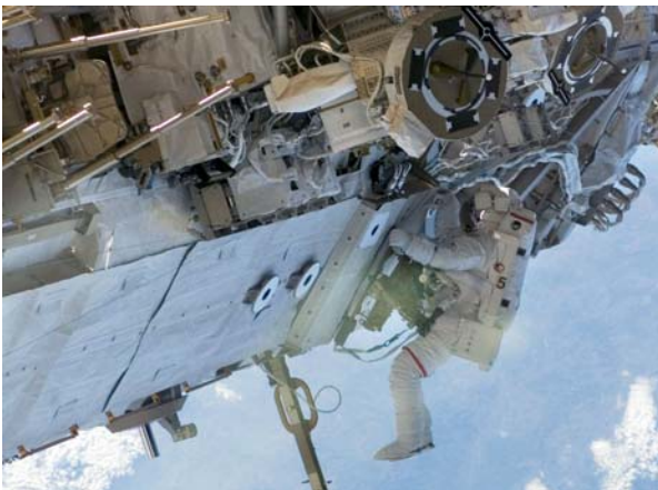
NASA-astronaut Joseph Tanner ansluter kablar den 12 september 2006 under STS-115-uppdraget, vilket installerade P3/4-fackverket på den internationella rymdstationen (Bild: NASA)
