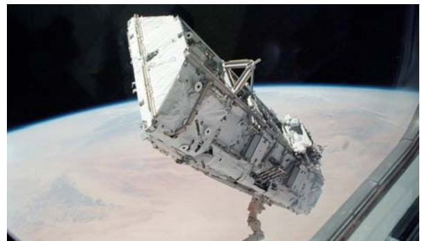
S0-fackverket flyttas till utsidan av rymdfärjan Atlantis lastrum av ISS robotarm under STS-110-uppdraget den 11 april 2002. (Bild: NASA)
