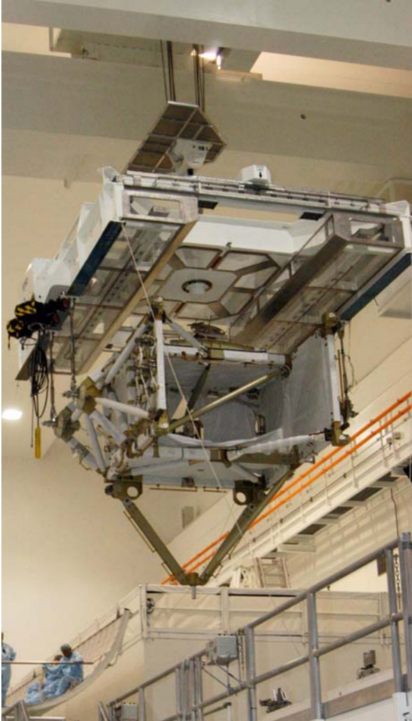
Fackverkssektionen P5 flyttas med kran mot nyttolast-behållaren (utanför bilden) vid hanteringsanläggningen på Kennedy Space Center i Florida i oktober 2006. Behållaren kommer att användas för att transportera P5 till startplattan när den ska lastas ombord på skytteln. (Bild: NASA/George Shelton)
