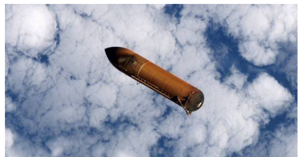
Den externa tanken vid STS-114-uppdraget "Återgång till flygning" efter separationen från rymdfärjan. (Image: NASA)
