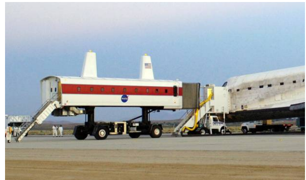
Besättningstransportfordon kör fram till rymdfärjan Discovery för att låta besättningen stiga ur efter landning av STS-114 den 9 augusti 2005. (Bild: NASA)
