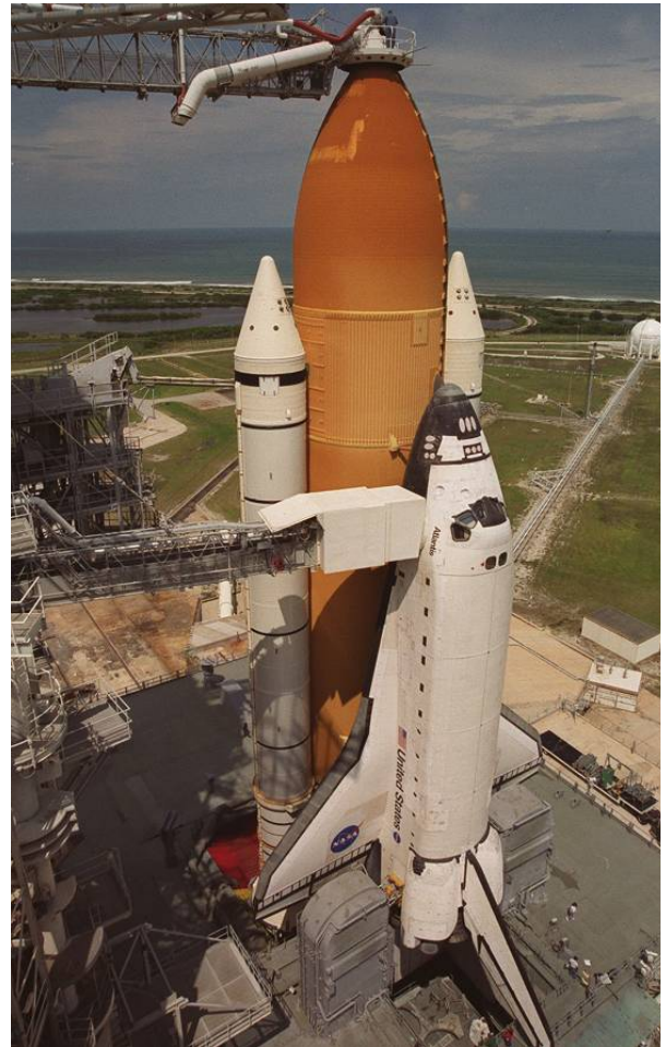
STS-106 på startplattan. Vita rummet är sammankopplat med rymdfärjan vid änden av rymdfärjans tillträdesarm. Man kan se "Beanie cap" överst på den externa tanken innan den tas bort. (Bild: NASA)
