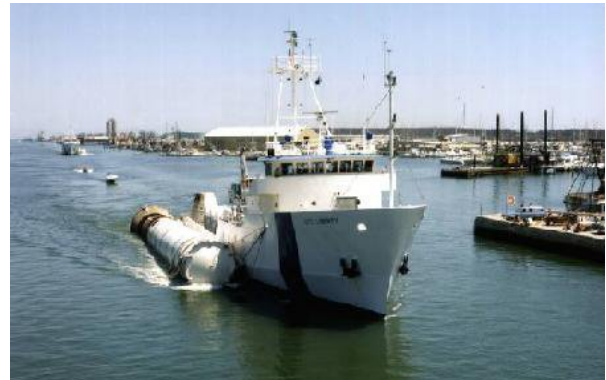
Fartyg som bogserar en förbrukad fastbränsleraket till återvinning. (Bild: NASA)
