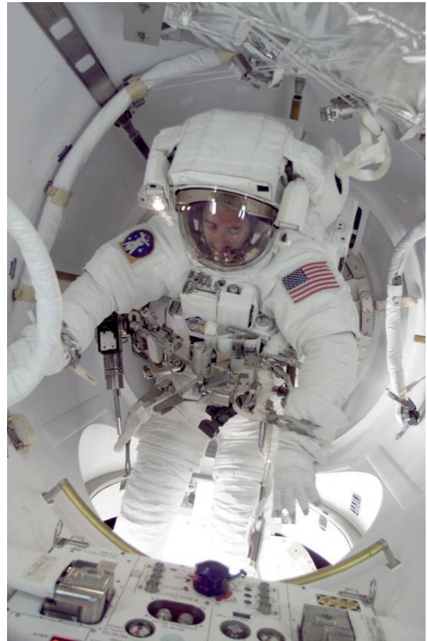
NASA-astronauten James Reilly lämnar den gemensamma luftslussen Quest under den allra första rymdpromenaden från den internationella rymdstationen i juli 2001. En tydlig bild av gränssnittet "Umbilical Interface Assembly" kan ses vid bildens nederkant. (Bild: NASA)
