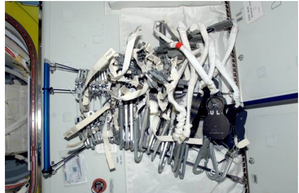
Vy av EVA-förankringar och förankringslinor i Quest-luftslussen på den internationella rymdstationen. (Bild: NASA)
