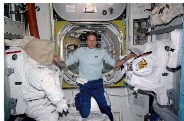
NASA-astronaut Michael Gernhardt i Quest utrustningssluss med EMU-rymddräkter under STS-104-uppdraget till ISS (12-24 juli 2001). Till höger ses överdelssektionen som innehåller de livsuppehållande systemen. (Bild: NASA)
