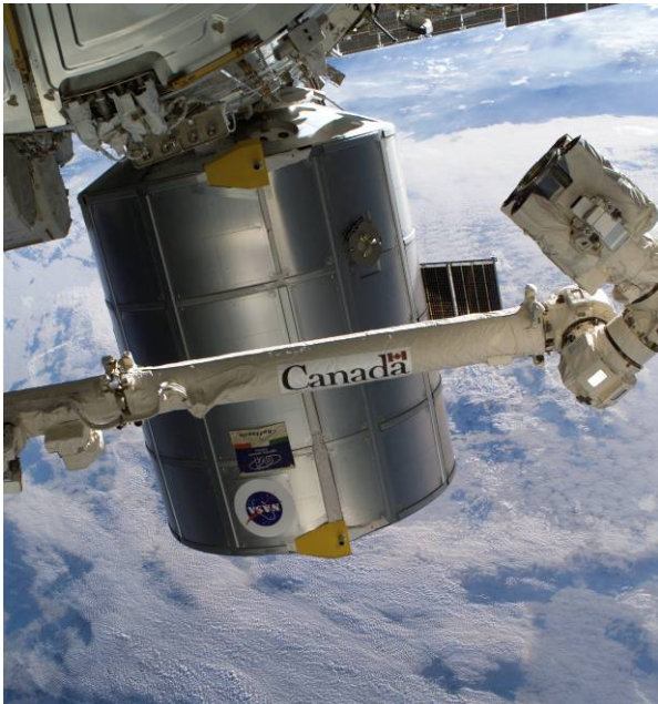
MPLM-modulen Raffaello dockad till ISS under STS-114-uppdraget den 3 augusti 2005. Stationens huvudrobotarm, Canadarm 2, ses framför MPLM-modulen (Bild: NASA)
